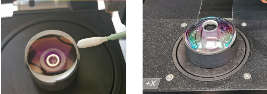
Abbildung 38: Links ein Achromat aus einem optischen Kohärenztomografen (Augenheilkunde) und rechts eine sphärische Linse mit Zentrierbohrung
